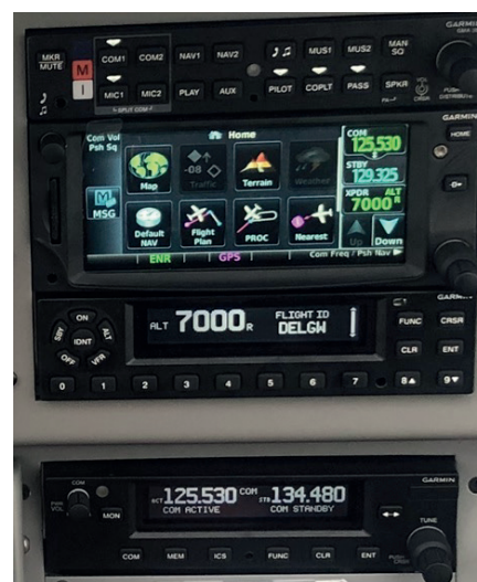
Alle electronica “praten” met elkaar. Van boven naar beneden: audio paneel, GPS/radio, transponder, tweede communicatieradio.
