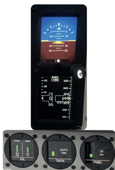
Ook de back-up vlieginstrumenten en motorinstrumenten zijn digitaal.
