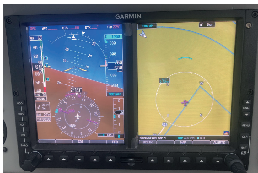
Meteen na het opstijgen van baan 26 past het navigatiescherm zich automatisch aan. Een rechts van ons gelegen gebied met beperkingen, de startbaan, de wind en een kompasroos zijn alle informatie die op dat ogenblik nuttig is.
