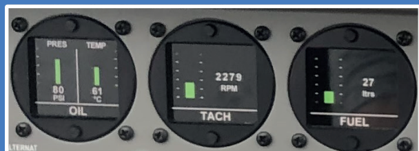
Ook de back-up vlieginstrumenten (boven) en motorinstrumenten (onder) zijn digitaal.
