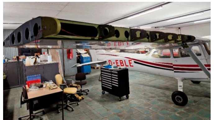
Aanvalsboord en vleugeltip geheel gedemonteerd om uit te deuken, inspectie uit te voeren en weer terug te plaatsen
